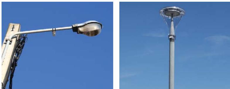
Notre commune poursuit régulièrement la modernisation de son réseau d'éclairage public avec pour objectif un passage complet à l'éclairage LED (diodes électroluminescentes) très économe en énergie; avec une durée de vie largement supérieure aux ampoules à décharges conventionnelles et un temps d'allumage instantané alors qu'il faut compter plusieurs minutes de chauffe pour une lampe classique.
